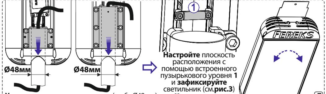
Установите светильник на консоль (трубу Ø48мм) до упора и заведите питающий провод внутрь.
