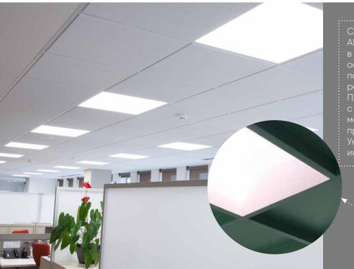
Светодиодные панели Feron AL2115 и AL2117 используются в любых помещениях, включая офисы, общественные помещения и квартиры. Драйверрасположен вне зоны видимости Пластиковый рассеиватель с эффектом 3D обеспечивает макисмальную светоотдачу при той же мощности. Универсален для разных типов интерьеров.
